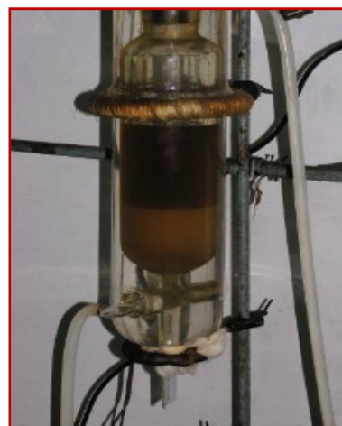
चित्र - 2: सीएसओ के एरोमैटिक्स निष्कर्षण के लिए प्रयोगशाला सेट-अप
